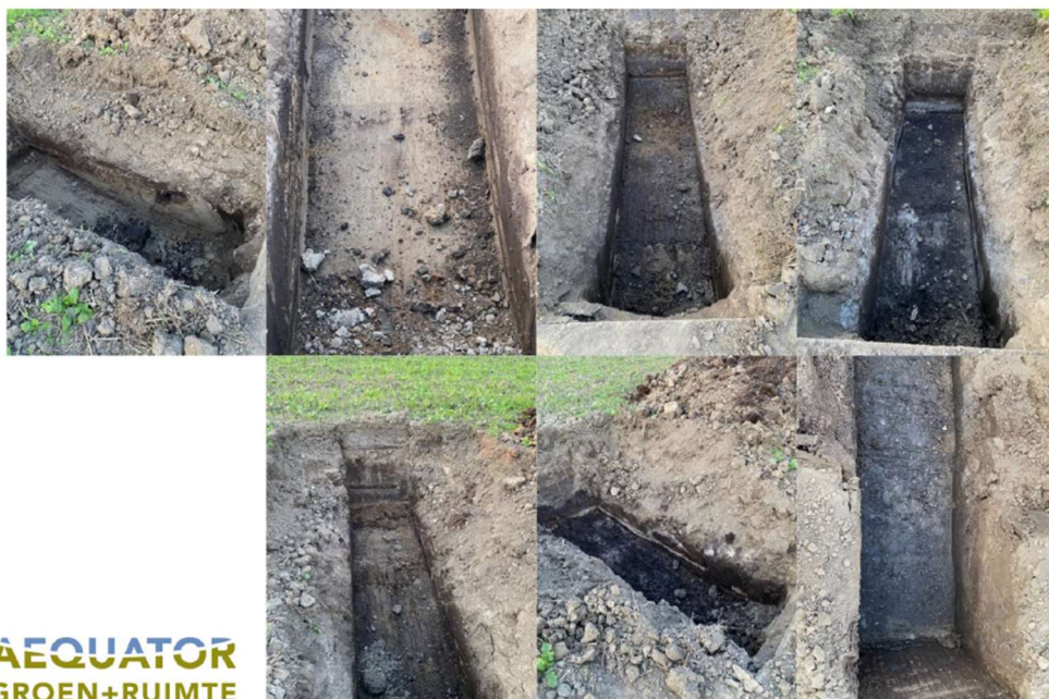
Profielkuilen bij Martin Boersma (oostelijk gelegen van de Drechtvaaggrond) laten de variatie in de ondergrond zien, klei, veen en pleistoceen zand wisselen elkaar op korte afstand af.
