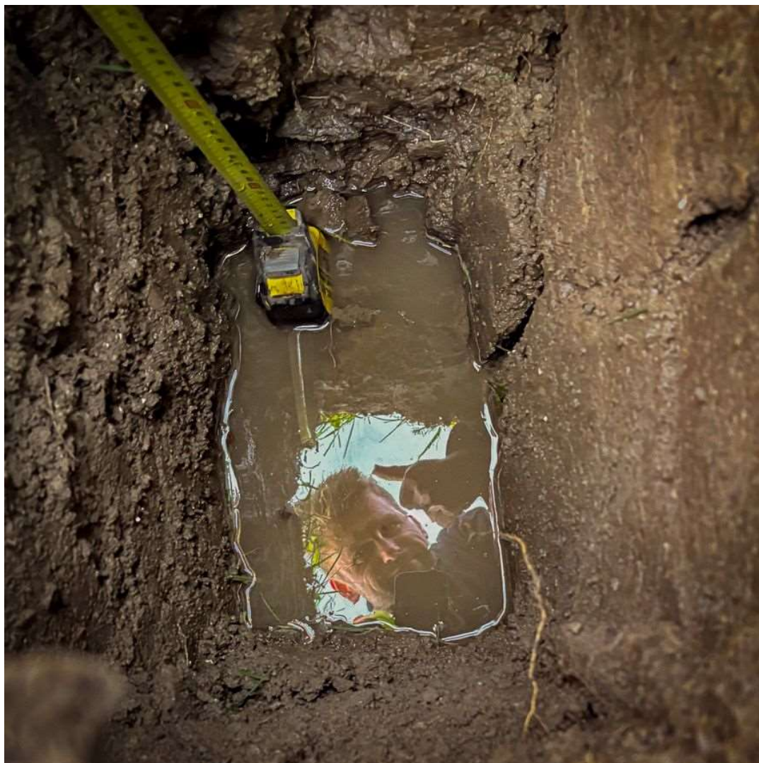
Profielkuil in november 2025. De rijpingsscheuren zijn goed zichtbaar. Het grondwater staat op 80 cm-mv.
